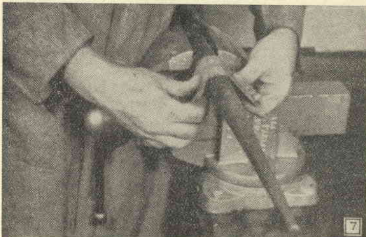
Foto 7 - Come viene eseguita una piega circolare su di una forma di metallo. Notate che il pezzo da piegare viene tenuto saldamente da ambedue le parti nel corso della operazione.
