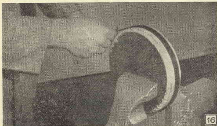
Foto 16 — L'uso di una forma di legno rende agevole il piegare un cerchio. Il blocco deve essere di diametro uguale al diametro interno del cerchio che si vuole ottenere.
